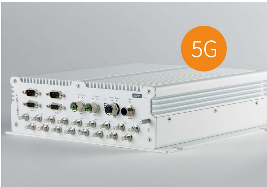
Bild 2: Zur Ausstattung des Wireless 5G-Gateway CyBox GW 2-P zählen vier Slots für verschiedene 5G/LTE- und WLAN-Modul-Kombinationen und eine integrierte SSD zum Speichern von Medieninhalten.
