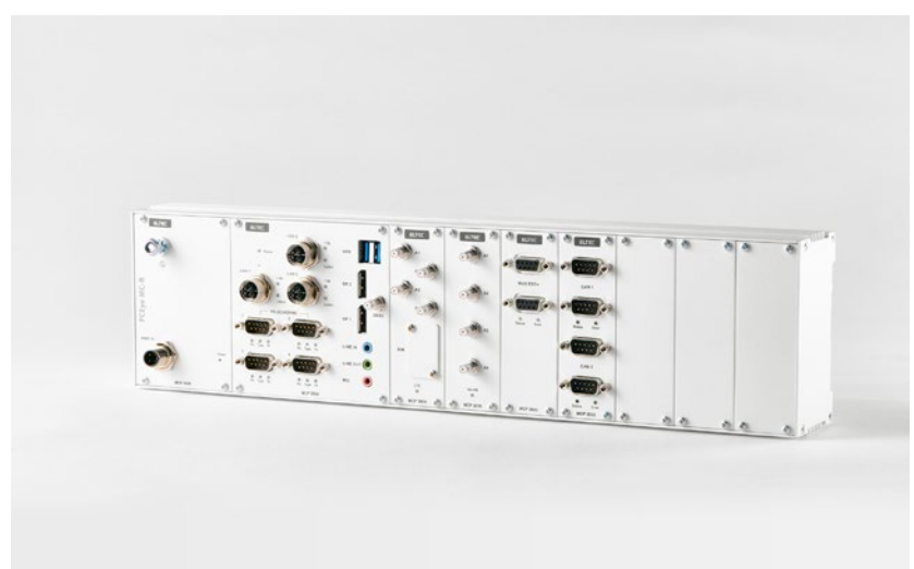
4: PCEye MC-R ist ein individuell konfigurierbarer BoxPC in kompakter Bauweise
